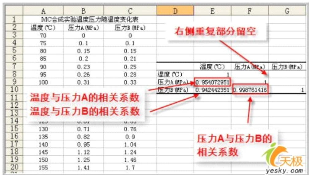
从数据统计结论能看出，温度和压力 A、B 的相关性分别达到了**0.95**和**0.94**，这说明他们呈现良好的正相关性，而两组压力数据间的相关性达到了**0.998**，这说明在不同反应器内的相同条件下反应一致性非常好，能忽略因为更换反应器造成的系统误差。
